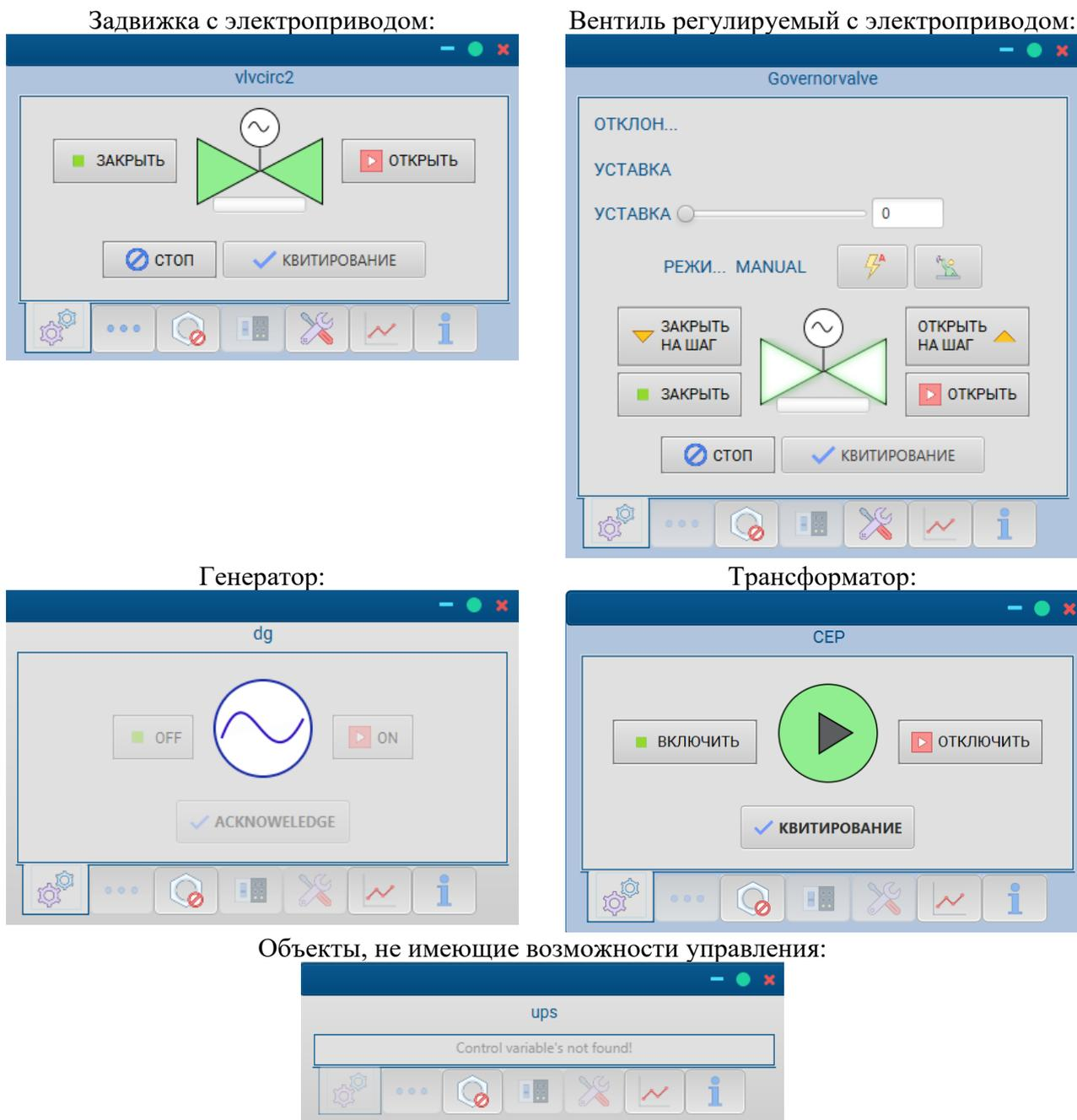
Рисунок 81 – Примеры отображения вкладки текущих данных / текущего состояния
