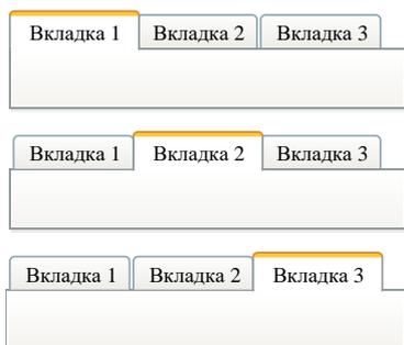
Вкладка (англ. tab) – элемент графического пользовательского интерфейса, позволяющий организовать большое количество одновременно отображаемой информации в рамках одного рабочего окна в специальных переключаемых областях.
